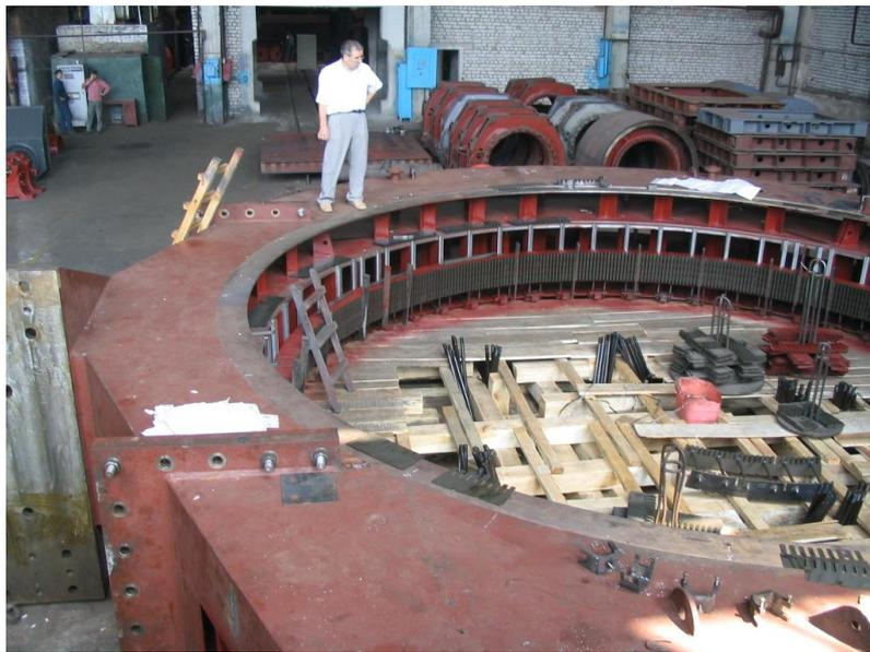
Электродвигатели синхронные, предназначены для привода рудоразмольных и сырьевых мельниц, применяемых в технологических линиях горно-обогатительных комбинатов. Двигатели могут быть использованы как для нового строительства, так и для замены ранее установленных двигателей старых серий СДМ(З) 2.
