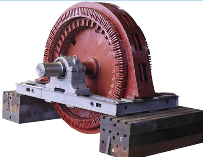
Электродвигатели синхронные, предназначены для привода рудоразмольных и сырьевых мельниц, применяемых в технологических линиях горно-обогатительных комбинатов. Двигатели могут быть использованы как для нового строительства, так и для замены ранее установленных двигателей старых серий: СДС -19; СДМ(З) 2.
