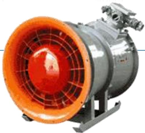
Вентиляторы шахтные местного проветривания — осевые, одноступенчатые, взрывозащищенного исполнения с электрическим приводом, уровень взрывозащиты РВ ЗВ. Предназначены для нагнетательного проветривания тупиковых горных выработок посредством подачи воздуха по гибкому и жесткому (металлическому) вентиляционному трубопроводу.
