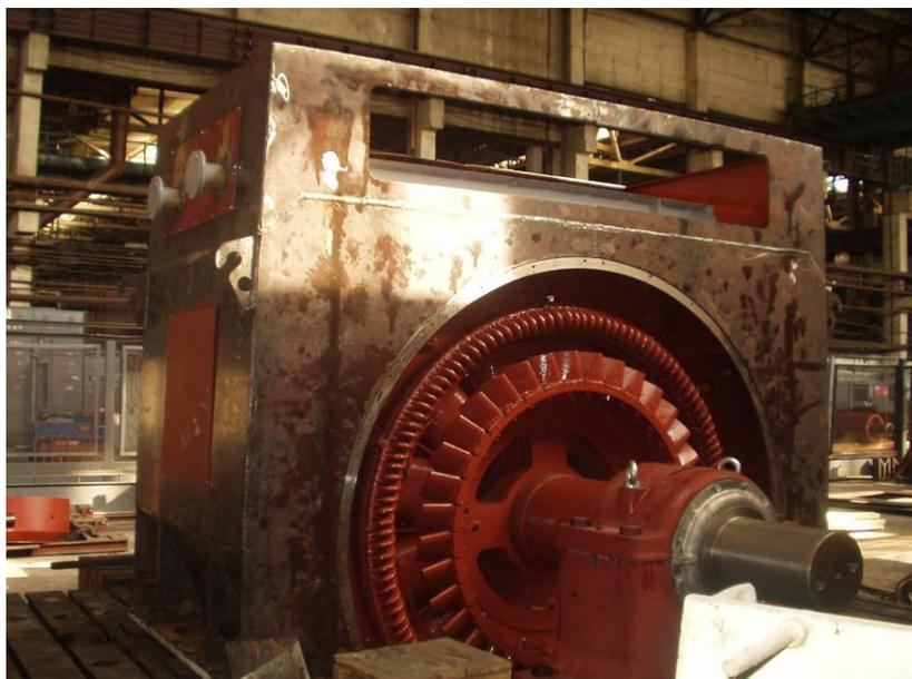
Электродвигатели синхронные, предназначены для привода рудоразмольных и цементных мельниц, применяемых в технологических линиях горно-обогатительных и цементных комбинатов. Двигатели могут быть использованы как для нового строительства, так и для замены ранее установленных двигателей.
