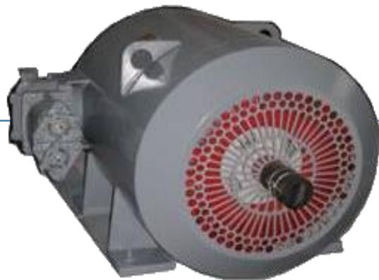
Двигатели асинхронные взрывобезопасные серии **2МА36 6 и 7 габаритов** с фазным (короткозамкнутым) ротором предназначены для продолжительного режима работы в подземных выработках угольных шахт и рудников, опасных по газу и пыли (группа I), а также в помещениях всех классов и наружных установках опасных по газопаровоздушным смесям (группа II).
