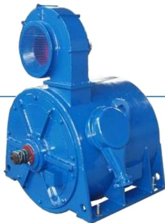
Предназначены для преобразования электрического напряжения и питания двигателей главных электроприводов экскаваторов в качестве комплектующих изделий. Агрегаты состоят из приводного синхронного двигателя и трех генераторов постоянного тока.
